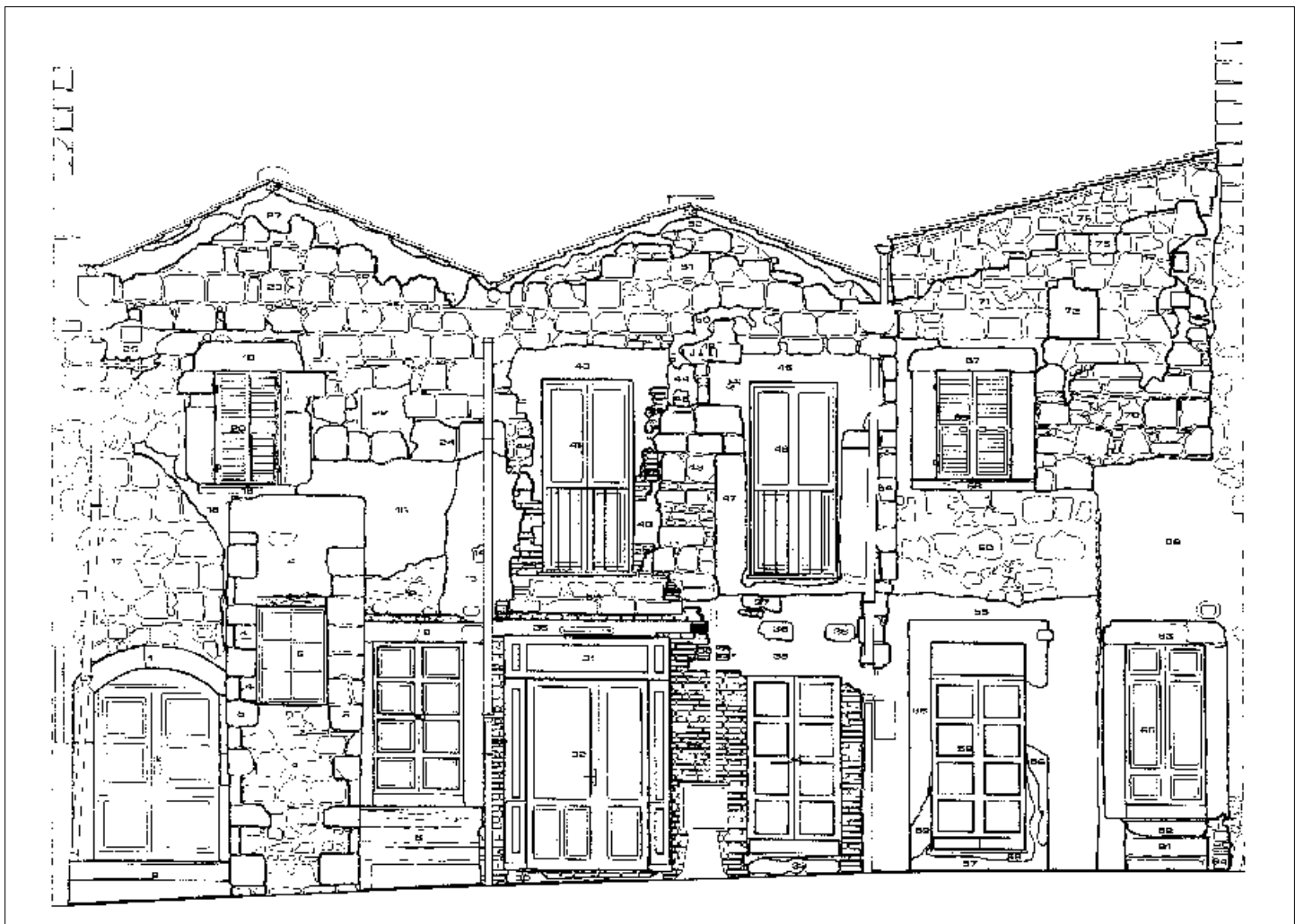
Blera, via Roma: rilievo delle facciate di case a schiera medievali con analisi stratigrafica (F. Santoni)
